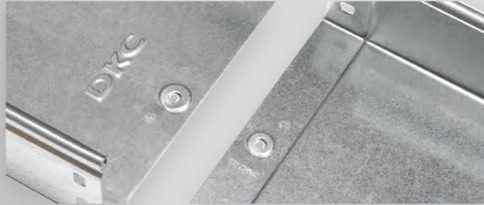
La presenza di una bordatura continua sui fianchi (bordi) sia delle basi che dei coperchi garantisce una maggiore tenuta ai carichi e consente l'assemblaggio di tutti i coperchi del sistema senza ricorso a viti o clips.
